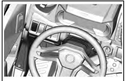
Mit diesem Schalter wird entweder die OFF-Stellung, das Abblendlicht oder das Fernlicht ausgewählt.
