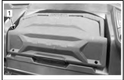
Zum Öffnen der Werkzeugbox lösen Sie die Abdeckung und heben den Deckel.
