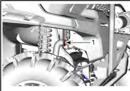
1. Tuyau inférieur du radiateur à débrancher
