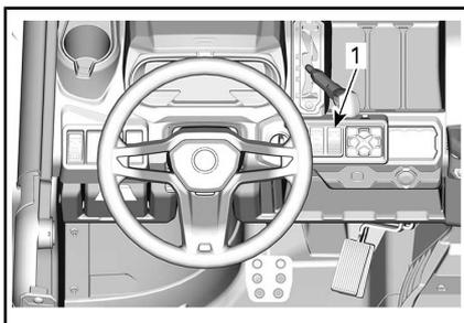
1. Interrupteur du mode du différentiel avant
