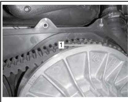
1. Partie la plus basse des pignons alignée avec la surface externe de la courroie d'entraînement
