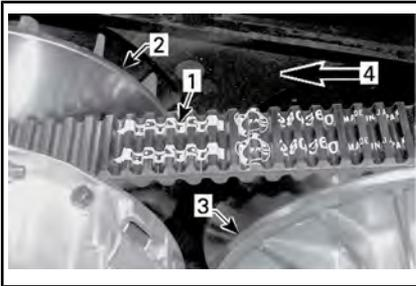
1. Flèche imprimée sur la courroie
