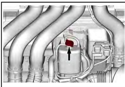
3. Dévissez le bouchon de vidange du liquide de refroidissement et vidangez-le dans un récipient approprié.
