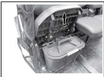
**REMARQUE :** Pour la remettre en place, vérifiez qu'elle est correctement alignée avec les tubes du siège et la forme du plancher, pour qu'elle s'enclenche correctement sous le siège.
