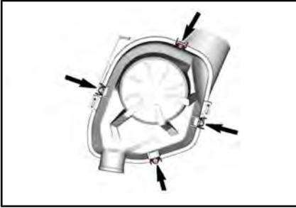
Entfernen Sie die Filterpatrone.
