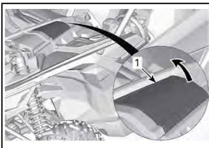
1. Vorderer Sicherungskasten
