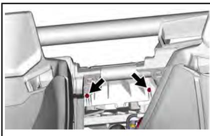
Entfernen Sie die Schutzplatte.
