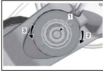
*EINFEDERUNGSDÄMPFUNG (NIEDRIGE GESCHWINDIGKEIT), (EINEN SCHRAUBENDREHER VERWENDEN)*
