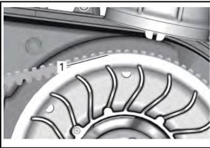
1. Unterster Teil der Zahnräder bündig mit der Abtriebsscheibenkante
