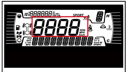
Anzeige der Fahrzeuggeschwindigkeit in km/h oder mph.
