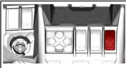
Das Stoßdämpfer-Symbol blinkt beim Wechsel des Modus.
