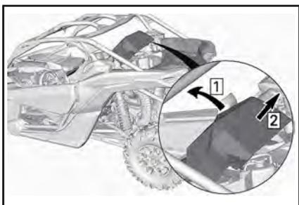
Entfernen Sie das CVT-Luftfilter vom Fahrzeug.
