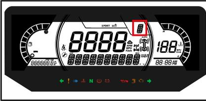
Diese Anzeige zeigt die Getriebebestellung an:
