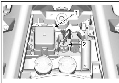
1. Vorderer Sicherungskasten
