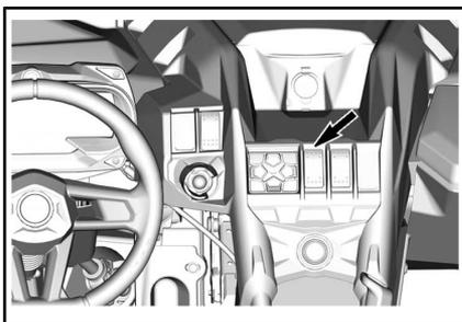
Mit diesem Schalter wird bei stehendem Fahrzeug und laufendem Motor der Zweirad- oder Vierrad­antriebsmodus ausgewählt.
