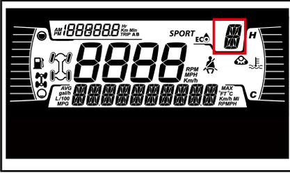
Diese Anzeige zeigt die Getriebestellung an:
