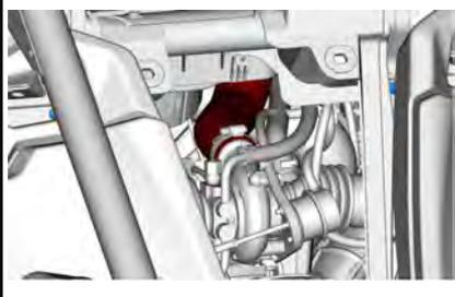
Den Ladeluftkühler und die Schlauchhalterung des Kurbelgehäuses durch Lösen der Schraube öffnen.
