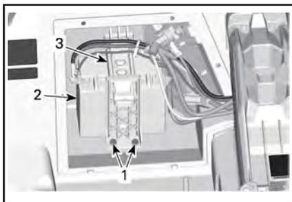
1. Halteschrauben des Batteriebügels
