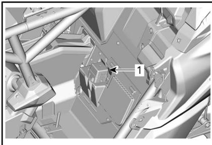
1. Hinterer Sicherungskasten
