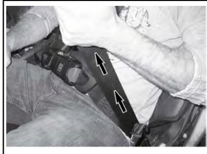
Um den Sitzgurt zu lösen, halten Sie mit einer Hand den Beckengurt und ziehen den roten Riemen nach aussen.
