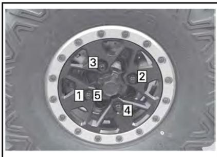
**ZUR BEACHTUNG** Verwenden Sie immer die für die Art des Rads empfohlenen Radmuttern. Durch Verwendung einer anderen Mutter könnten Sie die Felge oder die Radbolzen beschädigen.
