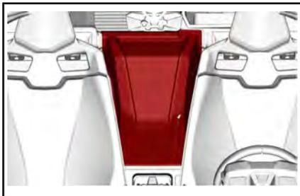
Entfernen Sie die vorderen Schutzplattenhalteschrauben.
