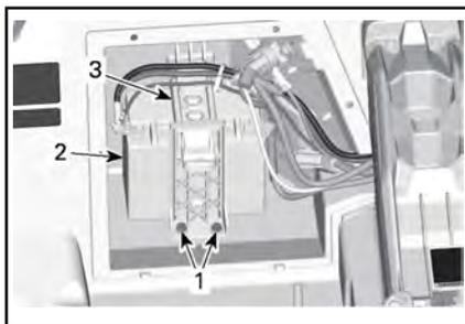
1. Vis de fixation du support de la batterie
