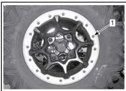
1. Les vis des roues à anneau de retenue doivent être serrées manuellement
