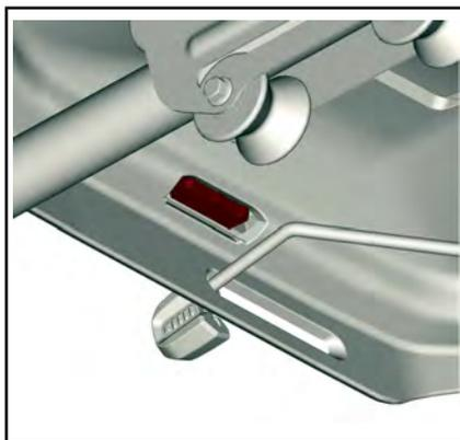
Soulevez l'arrière du coussin, puis dégagez le coussin du cadre du siège en le tirant vers l'arrière.
