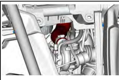
Ouvrez le refroidisseur intermédiaire et le support du tuyau de carter en retirant la vis.
