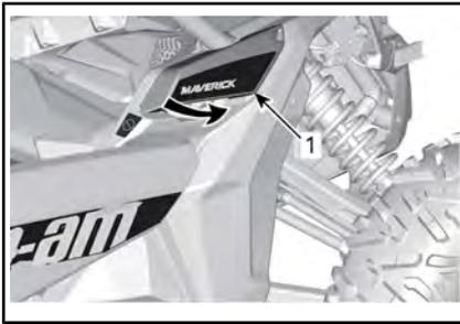
1. Couverture du bouchon de réservoir d'essence
