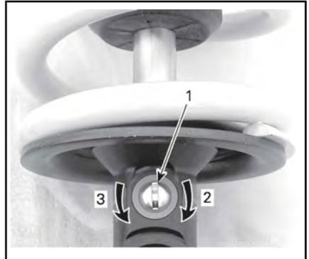
1. Dispositif de réglage de l'amortissement des rebonds
