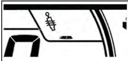
Cette icône apparaît et clignote lorsque vous ouvrez la sélection du mode de suspension ou lorsqu'une erreur de suspension se produit.
