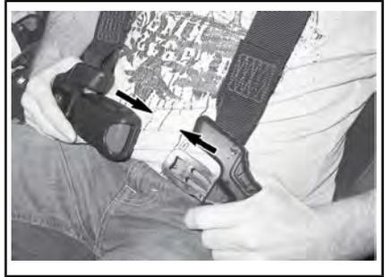
**Des deux côtés**, ajustez la ceinture en l'appuyant fermement sur votre corps en tirant la longueur excédentaire de la ceinture abdominale vers l'intérieur. La boucle doit être centrée à la taille (aussi bas que possible).
