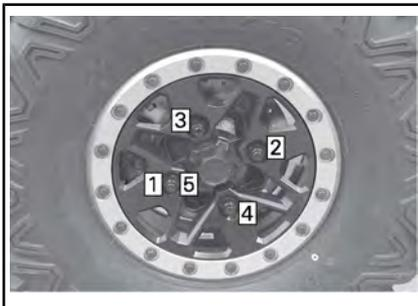
**AVIS** Utilisez toujours les écrous de roue recommandés pour le type de roue. D'autres écrous risquent d'endommager la jante ou les goujons.
