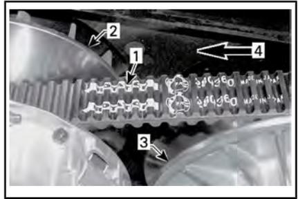
1. Flèche imprimée sur la courroie
