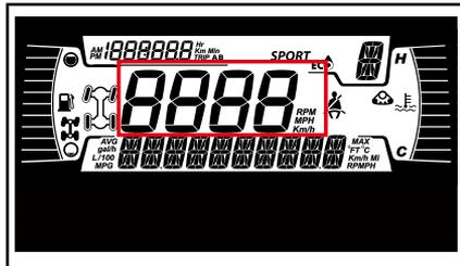
Indique la vitesse du véhicule en km/h ou en mi/h.
