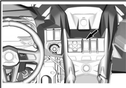
Ce sélecteur sélectionne le mode de traction à deux ou à quatre roues motrices lorsque le véhicule est arrêté et que le moteur tourne.
