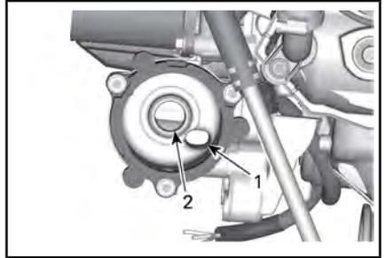
1. Orifice de sortie allant au système d'alimentation en huile du moteur
