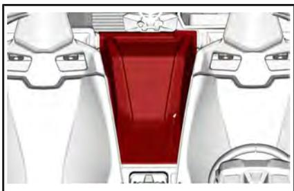
Remova os parafusos de retenção dianteiros da placa protetora.
