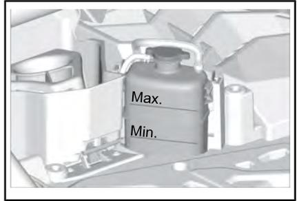
5. Geben Sie nach Bedarf Kühlmittel in das System. Mit einem Trichter vermeiden Sie das Verschütten von Flüssigkeit. **Nicht überfüllen.**
