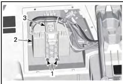
1. Vis de fixation du support de la batterie
