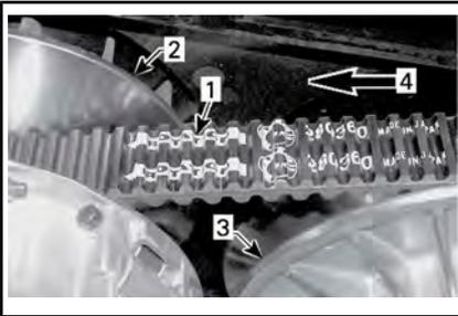
1. Flèche imprimée sur la courroie
