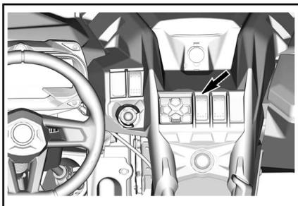
Ce sélecteur sélectionne le mode de traction à deux ou à quatre
