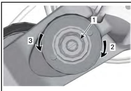
**AMORTISSEMENT DE COMPRESSION À HAUTE VITESSE (UTILISEZ UNE CLÉ DE 17 MM)**
