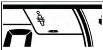
Cette icône apparaît et clignote lorsque vous ouvrez la sélection du mode de suspension ou lorsqu'une erreur de suspension se produit.
