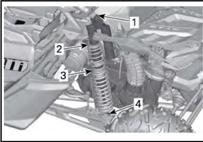
**TYPIQUE - AVEC AMORTISSEMENT DE REBOND - SUSPENSION ARRIÈRE**
