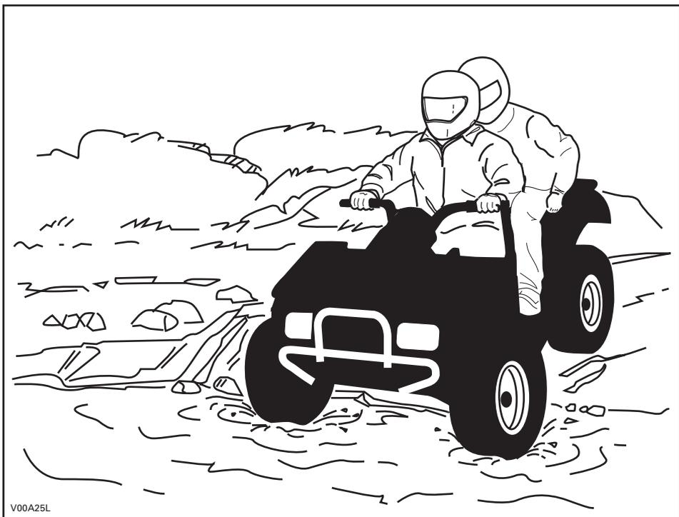
L'eau réduit la capacité de freinage. Après être sorti de l'eau, rouler à basse vitesse et actionner les freins quelques fois pour que la chaleur de la friction sèche les plaquettes. La distance de freinage peut varier lorsqu'on transporte un passager. Conduire plus lentement lorsqu'un passager vous accompagne. Prévoir davantage de distance pour freiner.
