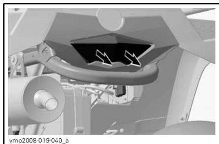
Tourner la douille et tirer dessus pour exposer l'ampoule.
