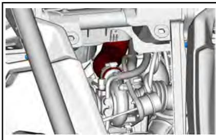
Remova o parafuso para abrir o intercooler e o suporte da mangueira do cárter.
