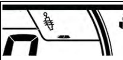
Este ícone é exibido e pisca quando se seleciona o modo de suspensão ou quando ocorre uma falha da suspensão.
