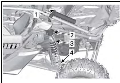
**TÍPICO - COM AMORTECIMENTO DO REBOTE E RESERVATÓRIO REMOTO - SUSPENSÃO TRASEIRA**
