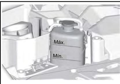
5. Adicione líquido de arrefecimento no sistema se necessário. Use um funil para não derramar. **Não complete além da capacidade.**
