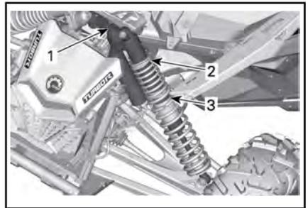
TÍPICO - SEM AMORTECIMENTO DO REBOTE - SUSPENSÃO DIANTEIRA
