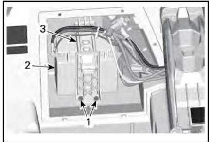
1. Parafusos de retenção do suporte da bateria
