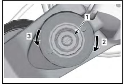
**AMORTECIMENTO POR COMPRESSÃO EM ALTA VELOCIDADE (USE UMA CHAVE INGLESIA DE 17 MM)**
