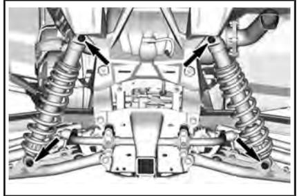
BEFESTIGUNGSTEILE FÜR HINTEREN STOßDÄMPFER
