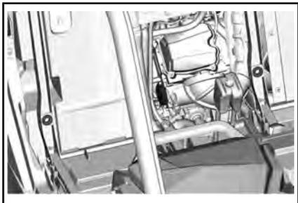
Entfernen Sie die Ölfilterabdeckung.
