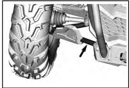
4. Binden Sie die Hinterreifen mit geeigneten Riemen fest.
