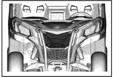
Überprüfen Sie den Kühler und die Schläuche auf Undichtigkeiten und andere Beschädigungen.
