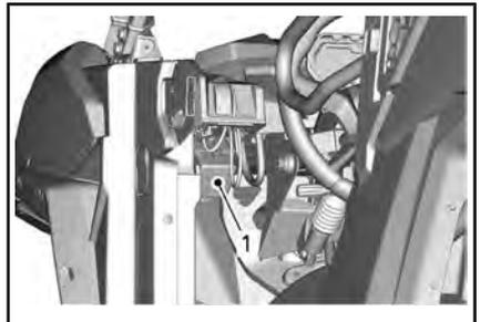
1. Vorderer Sicherungskasten
