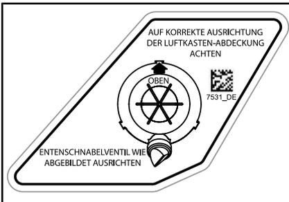
ADRESSE: DECKEL DES MOTOR-LUFTFILTERKASTENS
