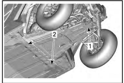
1. Hebestelle unter der Schutzplatte
