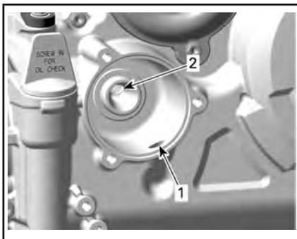
1. Einlass-Bohrung der Ölpumpe zum Ölfilter
