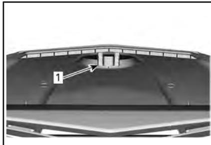
1. Schlitz an der Unterseite der Wartungsabdeckung finden
