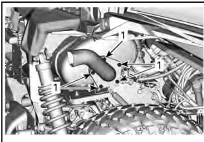
1. Parafusos de retenção do cano de escapamento
