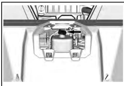
2. Adicione líquido de arrefecimento no sistema se necessário. Use um funil para não derramar. **Não complete além da capacidade.**
