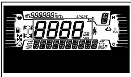
Exibe a velocidade do veículo em km/h ou MPH.
