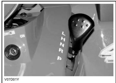
Para cambiar la posición de los engranajes de la transmisión, pare completamente el vehículo y mueva la palanca de cambio hasta la posición de la marcha deseada. No fuerce la palanca. Si no puede cambiar la marcha, pulse suavemente el acelerador y suéltelo inmediatamente; espere a que el motor baje de revoluciones hasta que se recupere un ralentí estable y entonces vuelva a intentarlo.
