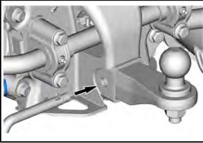
Fixez la goupille en place en repliant l'embout de verrouillage.
