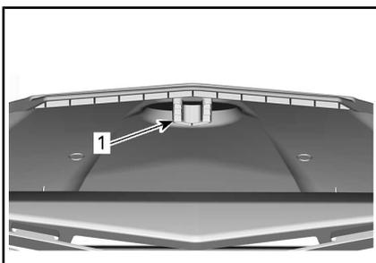
1. Positionnement de la fente sur le dessous du couvercle
