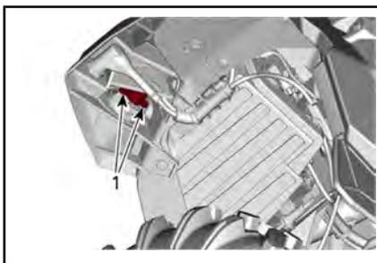
**DOUILLE DE L'AMPOULE DE CLIGNOTANT**
