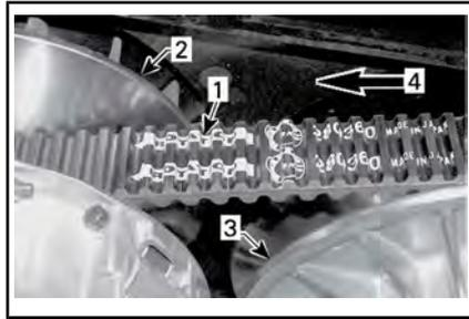
1. Flèche imprimée sur la courroie
