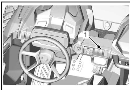
1. Interrupteur du mode du différentiel avant
