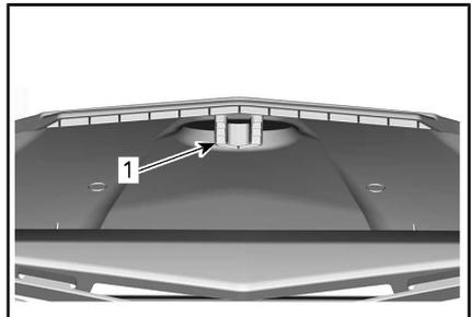
1. Positionnement de la fente sur le dessous du couvercle
