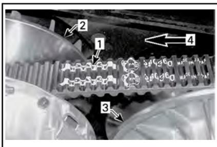
1. Flèche imprimée sur la courroie
