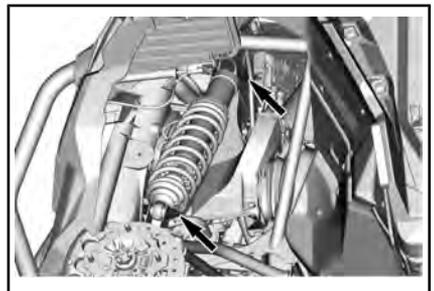
TEILE ZUR VERDEUTLICHUNG ENTFERNT – BEFESTIGUNGSTEILE FÜR STOßDÄMPFER VORNE
