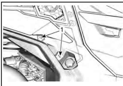
1. Girare i dispositivi di fissaggio di un quarto di giro
