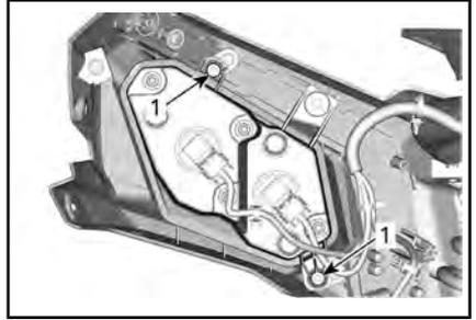
**1. Vite di regolazione****Sostituzione delle lampadine del fanalino**
