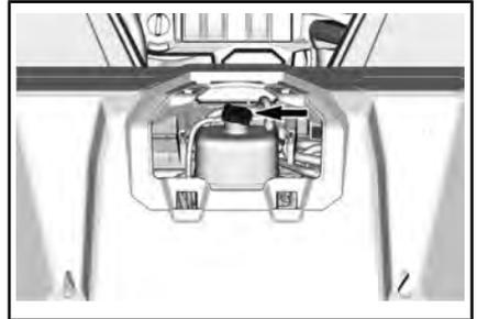
2. Aggiungere liquido refrigerante nel sistema se necessario. Usare un imbuto per impedire le perdite di liquido. **Non riempire eccessivamente.**
