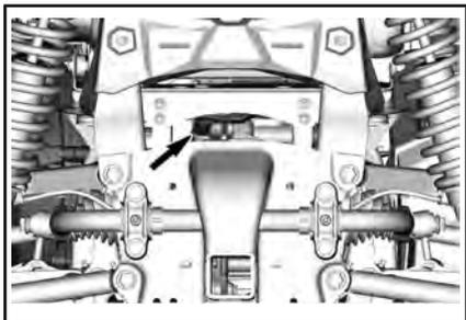
Sotto il veicolo, posizionare una bacinella per la raccolta dell'olio sotto il tappo di scarico.
