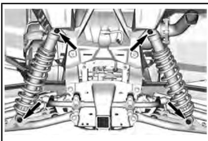
*BEFESTIGUNGSTEILE FÜR HINTEREN STÖßDÄMPFER*
