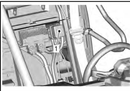
1. Hinterer Sicherungskasten
