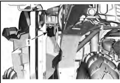
1. Vorderer Sicherungskasten
