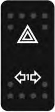
**HINWEIS:** Die Warnblinkleuchten können auch aktiviert werden, wenn das elektrische System des Fahrzeugs abgeschaltet ist.
