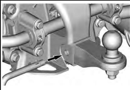
Sichern Sie den Stift durch Einklappen der Verriegelung.
