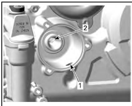
1. Einlass-Bohrung der Ölpumpe zum Ölfilter
