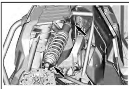
*TEILE ZUR VERDEUTLICHUNG ENTFERNT – BEFESTIGUNGSTEILE FÜR STÖßDÄMPFER VORNE*
