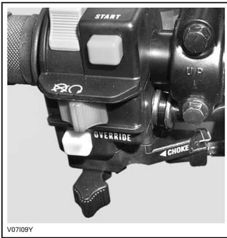
**CHOKE LEVER IN THE FULL CHOKE POSITION**
