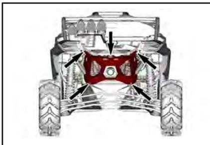
Enlevez et jetez les écrous et boulons de fixation.
