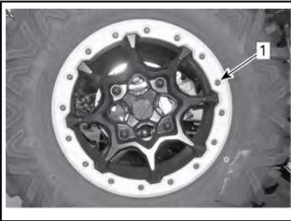
1. Les vis des roues à anneau de retenue doivent être serrées manuellement
