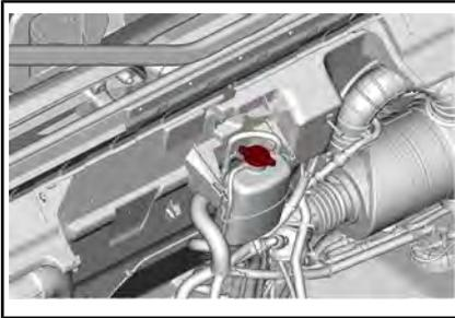
3. Svitare il tappo di scarico del liquido refrigerante di alcuni giri e scaricare il liquido in un contenitore idoneo.
