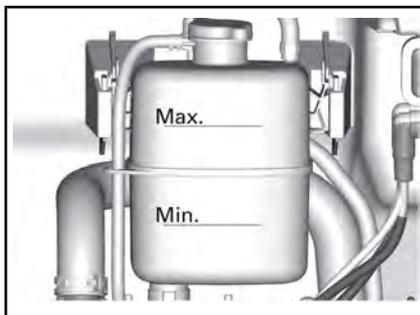
5. Aggiungere liquido refrigerante nel sistema se necessario. Usare un imbuto per impedire le perdite di liquido. **Non riempire eccessivamente.**
