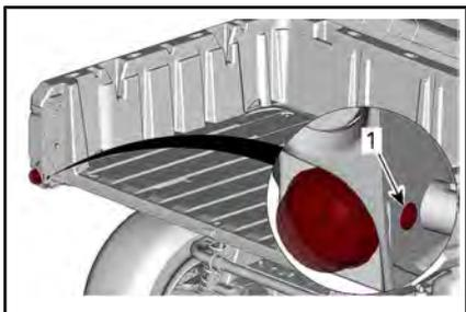
1. Vite di fissaggio della lente
