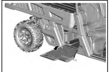
Schrauben Sie zum Entfernen der Batterieabdeckung die beiden Bajonnettverschlüsse ab.
