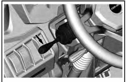
Wenn sich der Multifunktionshebel in der mittleren Stellung befindet, ist das Abblendlicht ausgewählt.
