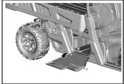
Rimuovere il coperchio della batteria svitando i due dispositivi di fissaggio di 1/4 di giro.
