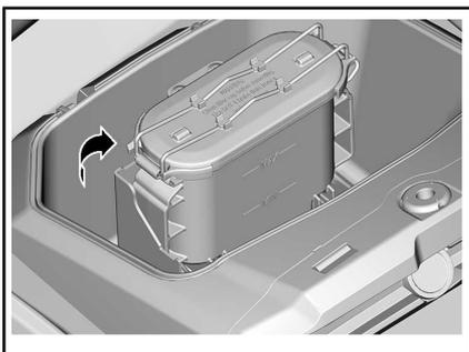
Füllen Sie Bremsflüssigkeit nach Bedarf auf. **Nicht überfüllen.**
