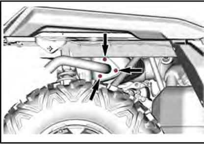
**BEFESTIGUNGSSCHRAUBEN DES ABGASROHRS**
