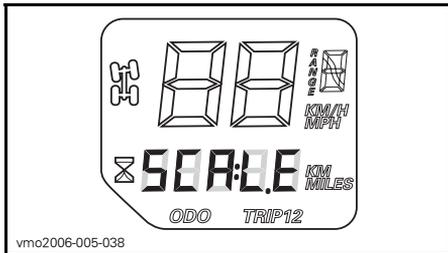
Se o velocímetro indicar **SCALE** no visor multifunções, isso significa que o sistema eléctrico foi activado com o botão do selector encravado na posição inferior ou carregado.
