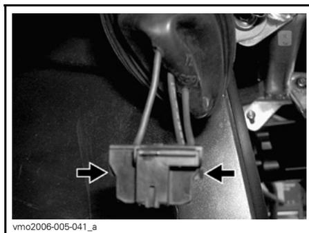
**CARREGUE NA PATILHA DE FIXAÇÃO PARA DESPRENDER O CONECTOR**
