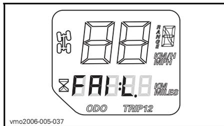
Se o velocímetro indicar **FALHA** no visor multifuncional, isso significa que detectou uma corrente de 18 volts no sistema eléctrico porque o regulador de tensão está desligado ou avariado.
