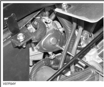
Führen Sie die Sprühspitze der Schmiermitteldose in das Ende des Gaszugreglers.
