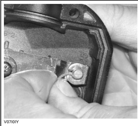
Entfernen Sie die seitliche Vergaserabdeckung.
