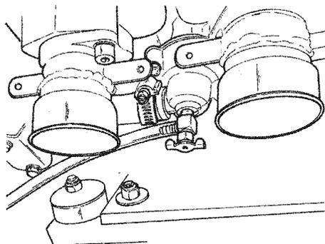
○ **REMARQUE:** L'extrémité ouverte du boyau de vidage doit être plus basse que la base du moteur.
