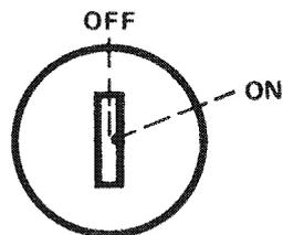
Commutateur à 2 positions (OFF/ON). Pour faire démarrer le moteur, tourner la clé vers la droite (position ON); pour l'arrêter, tourner vers la gauche (position OFF).
