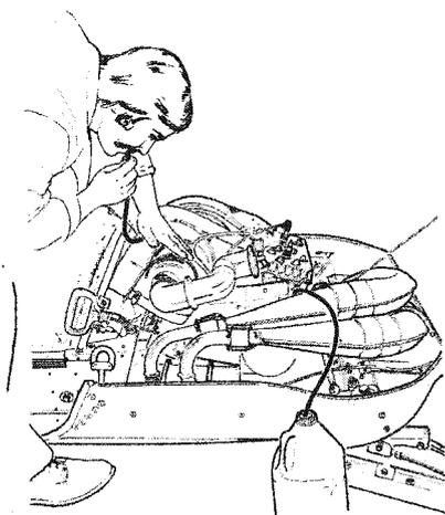
▼ **ATTENTION:** Pour prévenir la formation de rouille dans le système de refroidissement, le remplir de la solution recommandée de 60% d'antigel et 40% d'eau.
