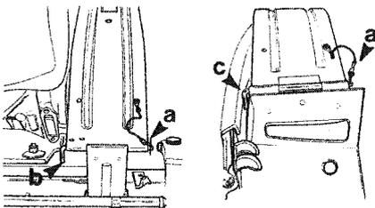
◆ **AVERTISSEMENT:** Lors de la dépose ou de l'installation de la cheville de retenue avant du garde-courroie, prendre garde de ne pas se brûler sur la tuyauterie d'échappement.
