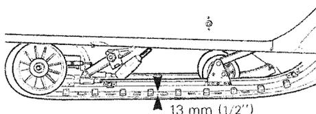
**ATTENTION:** S'il n'y en pas assez, la vitesse et le rendement en souffriront, et les pièces composantes de la suspension seront endommagées.
