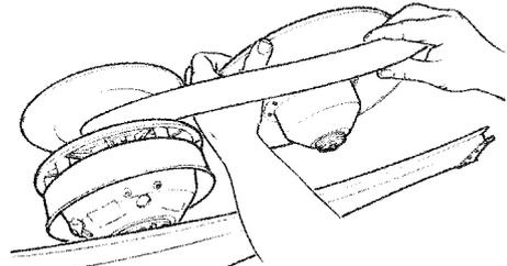
4. Faire glisser la courroie par-dessus la poulie motrice et la retirer du véhicule. Faire l'inverse pour reposer la courroie.
