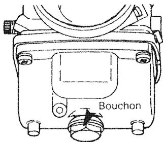
Remettre le bouchon et brancher le conduit d'alimentation.
