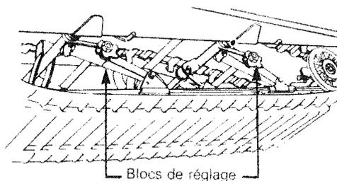
**ATTENTION:** Prendre soin de tourner les blocs de réglage de gauche dans le sens des aiguilles d'une montre; ceux de droite dans le sens contraire. À chaque réglage, les blocs gauches et droits doivent être placés à la même hauteur.
