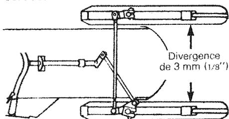
Le guidon doit en outre être à l'horizontale lorsque les skis sont orientés vers l'avant.
