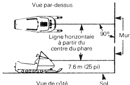
Après avoir correctement réglé la suspension et allumé le feu de route, c'est-à-dire l'éclairage le plus puissant, s'assurer que le centre du faisceau lumineux du feu de route (zone de haute intensité) est à 50 mm (2") sous la ligne horizontale du phare. Le conducteur doit alors être assis sur son véhicule.
