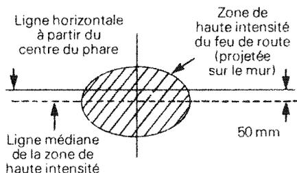
Pour effectuer un réglage, déposer la garniture chromée et serrer ou desserrer les quatre (4) vis de réglage.
