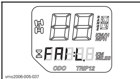
Se il tachimetro indica **FAIL** nel display multi-funzione, significa che il tachimetro ha rilevato 18 volt nel sistema elettrico, a causa di un regolatore di tensione scollegato o difettoso.
