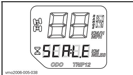
Se il tachimetro indica **SCALE** nel display multi-funzione, significa che il pulsante di selezione display si è bloccato quando è stato premuto o è stato premuto quando il sistema elettrico era attivato.
