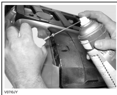
**NOTA:** Mettere uno straccio intorno al registro del cavo dell'acceleratore per evitare schizzi di lubrificante.
