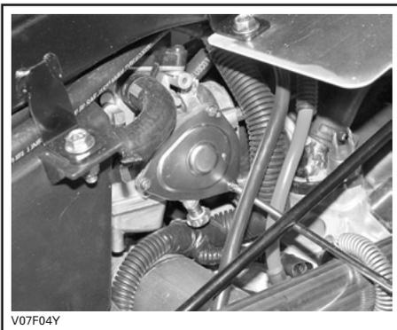
Inserire il beccuccio della bomboletta di lubrificante nel terminale del registro del cavo dell'acceleratore.
