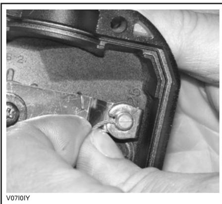
Rimuovere la copertura laterale del carburatore.
