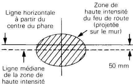
Pour effectuer un réglage, déposer la garniture chromée et serrer ou desserrer les quatre (4) vis de réglage.
