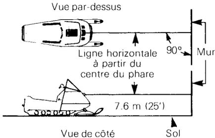
Après avoir allumé le feu de route, c'est-à-dire l'éclairage le plus puissant, s'assurer que le centre du faisceau lumineux du feu de route (zone de haute intensité) est à 50 mm (2") sous la ligne horizontale du phare. Le conducteur doit alors être assis sur son véhicule.
