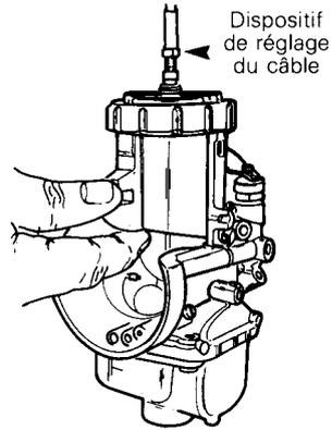
◆ **AVERTISSEMENT:** Il est important d'effectuer le réglage de l'ouverture du tiroir d'accélérateur afin de s'assurer du bon fonctionnement du mécanisme de l'accélérateur.
