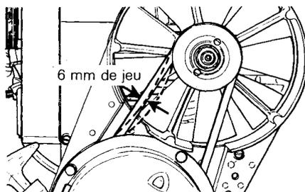
Si la courroie semble endommagée ou si sa tension est inadéquate voir le concessionnaire.
