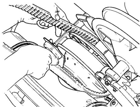
◆ **AVERTISSEMENT:** Il peut être nécessaire de desserrer le dispositif de réglage du frein afin de pouvoir soulever facilement l'arbre de renvoi. Toujours s'assurer que le disque de frein est correctement installé entre les garnitures de frein et que le mécanisme de freinage est bien réglé. Vérifier le fonctionnement du feu d'arrêt.
