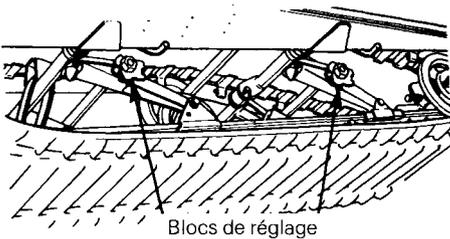
**ATTENTION:** Prendre soin de tourner les blocs de réglage de gauche dans le sens des aiguilles d'une montre; ceux de droite dans le sens contraire. À chaque réglage, les blocs gauches et droits doivent être placés à la même hauteur.
