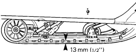
**ATTENTION:** S'il n'y en pas assez, la vitesse et le rendement en souffriront, et les pièces composantes de la suspension seront endommagées.
