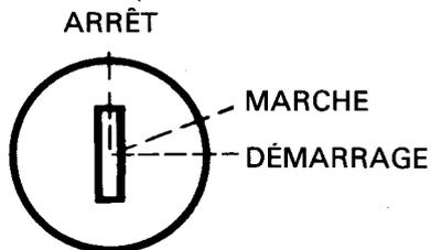
Commutateur à 3 positions (ARRÊT/ MARCHÉ/DÉMARRAGE). Pour faire démarrer le moteur, tourner la clé vers la droite (position "DÉMARRAGE"). Dès que le moteur tourne, laisser la clé revenir à "MARCHÉ". Pour arrêter le moteur, tourner la clé vers la gauche (position "ARRÊT").
