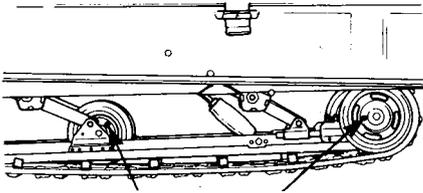
Raccords de graissage
