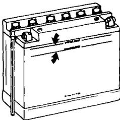
▼ **ATTENTION:** Ne pas laisser pénétrer le détersif à l'intérieur de la batterie. Il pourrait dégrader l'électrolyte.
