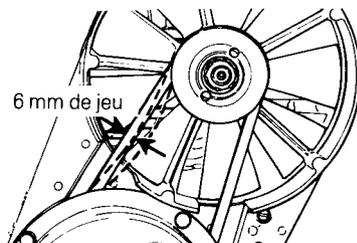
Si la courroie semble endommagée ou si sa tension est inadéquate voir le concessionnaire.
