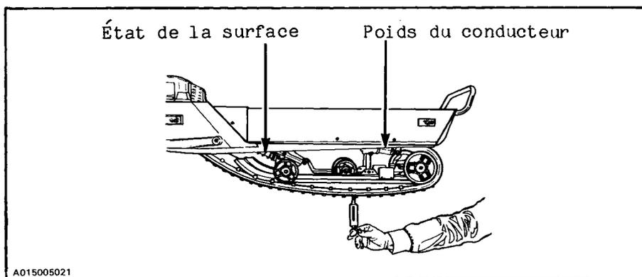
Pour ajuster, utiliser la clé de réglage accompagnant le véhicule. Vaporiser du WD 40 entre le ressort et le collet du ressort.
