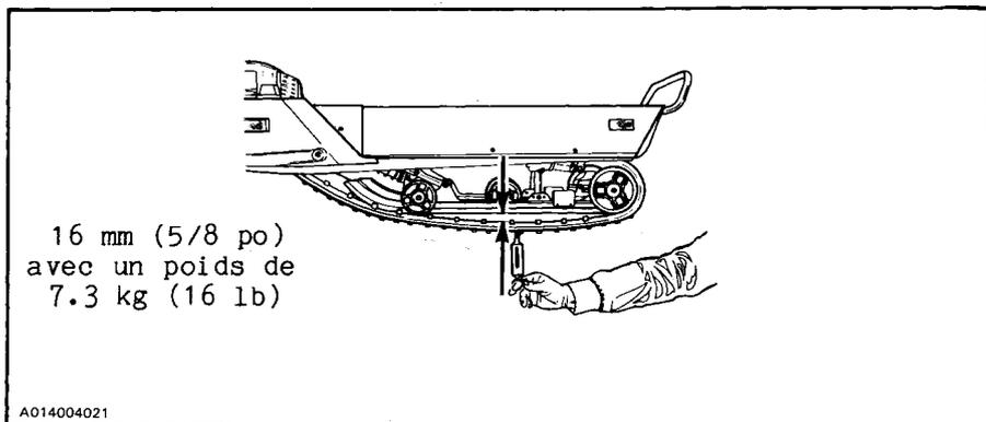
▼ **ATTENTION:** Une tension excessive entraînera une perte de puissance et des tensions excessives au niveau des pièces de la suspension.
