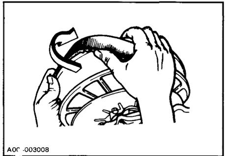
5. Faire glisser la courroie par-dessus la poulie motrice et la retirer du véhicule.
