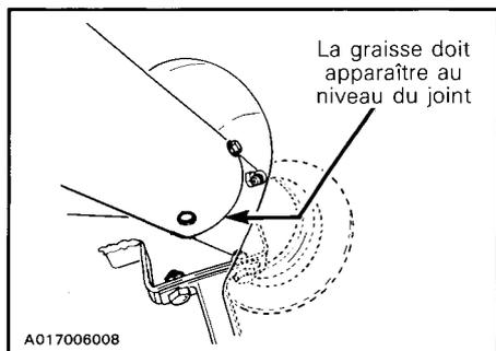
Huiler les joints à rotule de la barre d'accouplement ainsi que les coussinets supérieur et inférieur de la colonne de direction.
