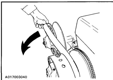
4. Enlever complètement la courroie de la poulie menée, en la maintenant à plat sous le rebord extérieur de la poulie menée.
