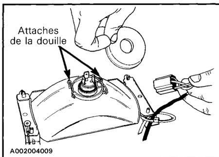
Si le feu arrière est grillé, enlever la lentille rouge et remplacer l'ampoule.
