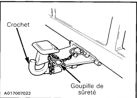
**AVERTISSEMENT:** Lors du remorquage d'un traîneau ou d'une remorque, toujours s'assurer de verrouiller le crochet au moyen de la goupille de sûreté.
