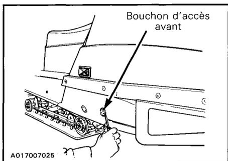
Lubrifier le raccord de graissage au moyen de graisse basse température, et remettre ensuite le bouchon d'accès en place.
