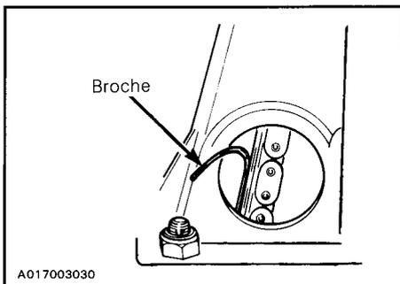
Introduire l'huile par l'orifice de remplissage. Utiliser l'huile à carter de chaîne Bombardier (N/P 413 8019 00, 250 ml).
