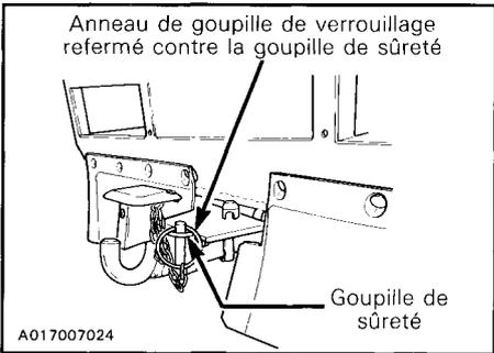
**REMARQUE:** Pour que l'attelage demeure verrouillé, insérer la goupille de verrouillage dans le pôteau d'attelage, en plaçant son côté plat contre la plaque d'attelage.
