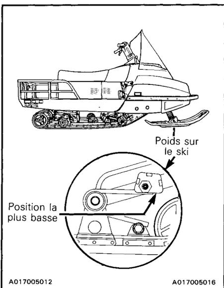
À la position la plus haute, le poids est transféré à la chenille, permettant ainsi une meilleure traction pour tirer une charge.
