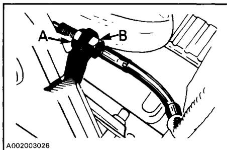
Après avoir effectué ce réglage, resserrer solidement les écrous A et B. Si le jeu demeure inadéquat, effectuer un réglage plus poussé.
