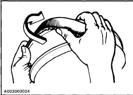
4. Faire glisser la courroie par-dessus la poulie motrice et la retirer du véhi-cule. Faire l'inverse pour reposer la courroie en portant attention aux points suivants.
