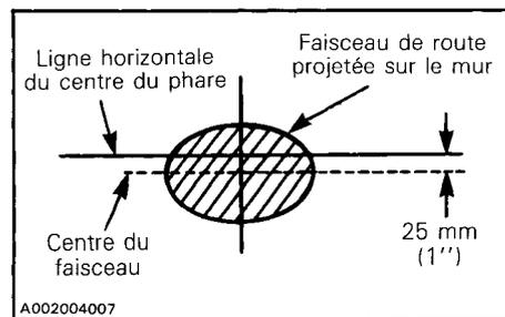
Pour effectuer un réglage, serrer ou desserrer les quatre (4) vis de réglage.
