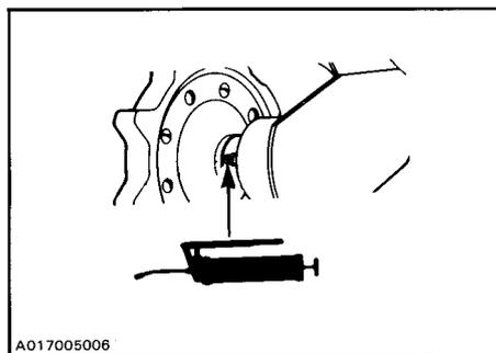
▼ **ATTENTION:** Lors du graissage des roulements de l'essieu arrière, ne pas appliquer trop de graisse, sinon l'anneau d'étanchéité sera éjecté de son logement. Vérifier la position de l'anneau d'étanchéité avec le doigt.
