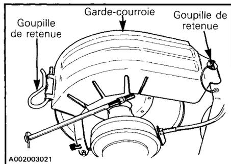
3. Pour déposer le garde-poulie de la poulie motrice, retirer la pince d'attache (A) et pousser le boulon à ressort (B) vers l'extérieur du véhicule pour dégager la cheville.
