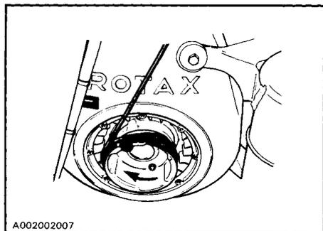
◆ **AVERTISSEMENT:** Après un démarrage au moyen de la poulie de démarrage, en cas d'urgence, ne pas réinstaller l'ensemble du démarreur.
