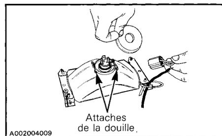
Si l'ampoule du feu arrière est grillée, enlever la lentille rouge et remplacer l'ampoule.
