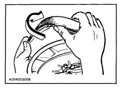
5. Faire glisser la courroie par-dessus la poulie motrice et la retirer du véhicule.
