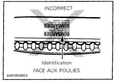
ATTENTION: Ne pas forcer la courroie ni utiliser d'outils pour la passer par-dessus les poulies lors de l'installation, sinon ses cordes pourraient se couper ou se briser.
