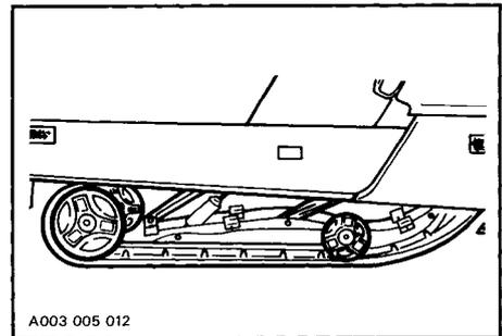
Ce type de suspension ne requiert aucune lubrification.
