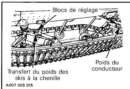
Lorsque les blocs de réglage avant sont au point le plus bas, le poids porte sur les skis.
