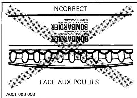
**ATTENTION:** Ne pas forcer la courroie ni utiliser d'outils pour la passer par-dessus les poulies lors de l'installation, sinon ses cordes pourraient être coupées ou brisées.
