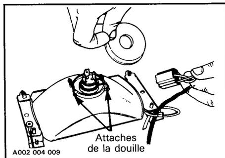
Si le feu arrière est grillé, enlever le diffuseur rouge et remplacer l'ampoule.
