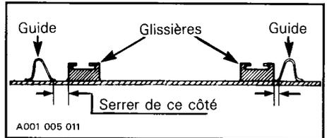
Resserrer les écrous de blocage et révérier l'alignement.
