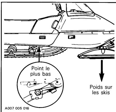
En les réglant à la position la plus élevée, on déplace la pression des skis à la chenille. Les blocs arrière sont réglés en fonction des préférences du conducteur.
