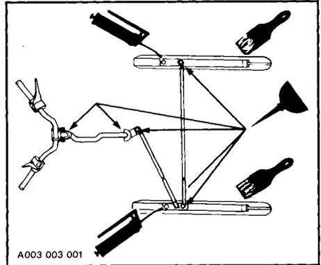
Huiler les boulons des coupleurs de ressorts, les joints à rotule et les douilles de la colonne de direction.
