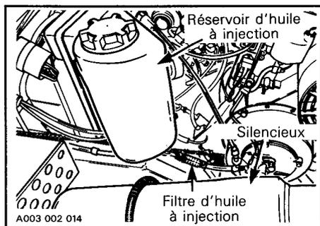
▼ **ATTENTION:** Un filtre d'huile à injection obstrué causera une insuffisance d'huile vers le moteur et occasionnera donc de graves dommages.
