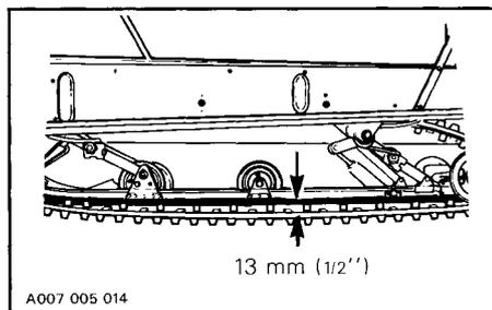
**ATTENTION:** Une tension excessive occasionnera une perte de puissance et une contrainte exagérée au niveau des pièces de la suspension.
