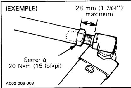
◆ **AVERTISSEMENT:** Le logement du joint à rotule sphérique doit être parallèle au bras de direction. Maintenir la barre d'accouplement en place pendant le serrage des écrous.
