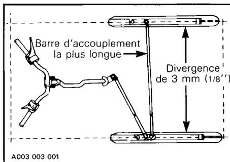
Le guidon doit de plus être à l'horizontale lorsque les skis sont orientés vers l'avant.
