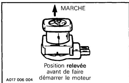
S'assurer que le capuchon coupe-circuit est en place et que la corde est rattachée au conducteur.
