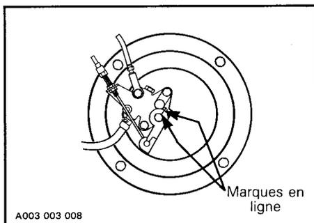
▼ **ATTENTION:** Le carburateur doit être ajusté avant la pompe à injection d'huile. S'assurer que la vitesse de ralenti est de 1100-1300 tr/mn.
