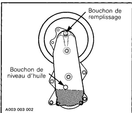
L'huile doit arriver au bas de l'orifice de visite. Remplir au besoin avec de l'huile à carter de chaîne Bombardier (N/P 413 8019 00 - 250 ml (9 oz)).
