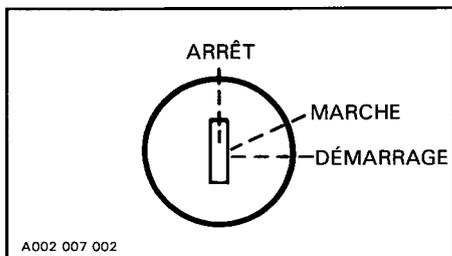
Interrupteur à 3 positions (ARRÊT/MARCHE/DÉMARRAGE). Pour faire démarrer le moteur, tourner la clé à la position "DÉMARRAGE" et la tenir. Dès que le moteur démarre, laisser la clé revenir à "MARCHE". Pour arrêter le moteur, tourner la clé à la position "ARRÊT".
