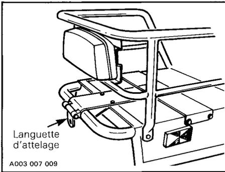
Le véhicule comporte un attelage à languette sur le pare-chocs arrière. Un crochet peut être installé sur l'attelage actuel.
