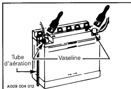
◆ **AVERTISSEMENT:** Le tube d'aération ne doit pas être obstrué, sinon les gaz s'accumuleront et une explosion pourra survenir. Éviter tout contact de l'électrolyte avec la peau.
