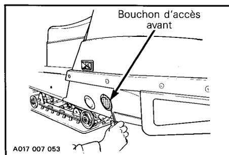
Lubrifier au moyen de graisse basse température, et remettre ensuite les bouchons d'accès en place.
