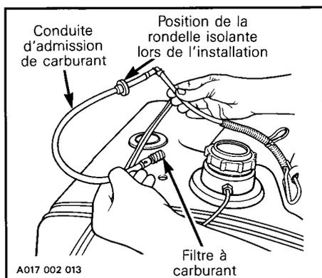
Remplacer le filtre à carburant. Pour faciliter l'installation de la conduite de carburant, glisser la rondelle isolante sur la conduite à environ 50 mm (2 po) du coude. Placer ensuite la rondelle sur le réservoir de carburant et insérer le coude dans la rondelle.
