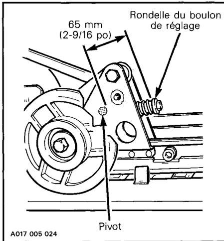
○ **REMARQUE** : Le conducteur peut effectuer cet ajustement en fonction de ses besoins particuliers. Si, par exemple, le véhicule est utilisé la plupart du temps pour tirer une charge, et rarement en marche arrière, il est possible de verrouiller le pivot arrière en serrant au maximum le boulon de réglage, permettant ainsi une meilleure traction et une direction plus positive.
