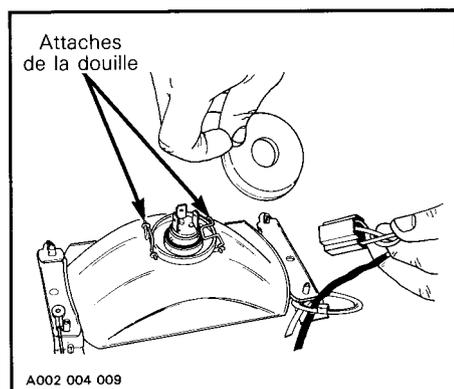
Si le feu arrière est grillé, enlever la lentille rouge et remplacer l'ampoule.
