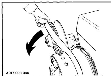
5. Enlever complètement la courroie de la poulie menée, en la maintenant à plat sous le rebord extérieur de la poulie menée.
