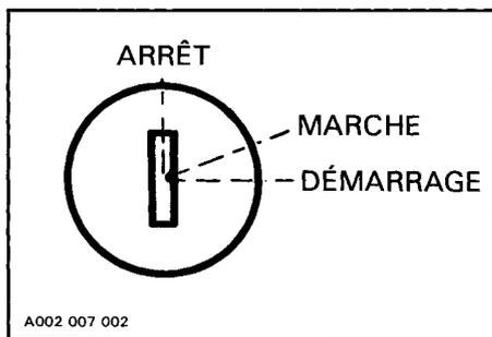
Commutateur à trois positions. Pour faire démarrer le moteur, tourner la clé à la position DÉMARRAGE et la tenir. Dès que le moteur tourne, laisser la clé revenir à MARCHÉ. Pour arrêter le moteur, tourner la clé à la position ARRÊT. Si le moteur ne démarre pas à la première tentative, ramener à chaque fois la clé à la position ARRÊT.
