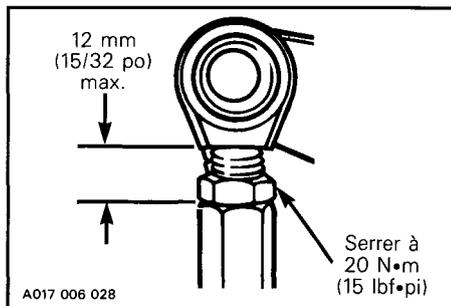
◆ **AVERTISSEMENT : La douille du joint à rotule doit être parallèle au bras de direction et à l'autre joint à rotule. Retenir la douille en serrant les écrous de blocage du joint à rotule.**
