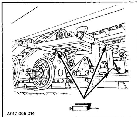
— Enduire de graisse l'intérieur du coussinet de la barre stabilisatrice de la suspension arrière.
