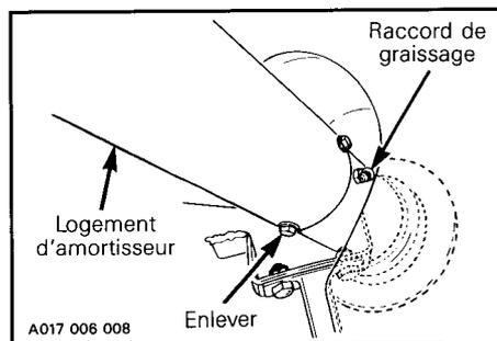
Lubrifier jusqu'à ce que la graisse apparaisse par l'orifice. Boucher ensuite solidement l'orifice au moyen d'un doigt, et continuer à lubrifier lentement jusqu'à ce que la graisse apparaisse au niveau du joint.
