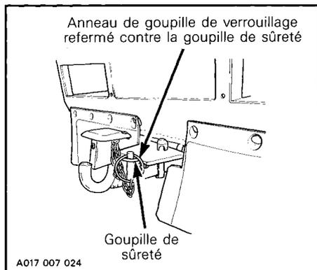
○ **REMARQUE :** Pour que l'attelage demeure verrouillé, insérer la goupille de verrouillage dans le pôteau d'attelage, en plaçant son côté plat contre la plaque d'attelage.
