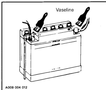
◆ **AVERTISSEMENT** : Le tube d'aération ne doit pas être obstrué, sinon les gaz s'accumuleront et une explosion pourrait survenir. Éviter que l'électrolyte ne vienne en contact avec la peau. Les émanations d'une batterie en cours de charge explosent très facilement. Toujours charger dans un endroit bien aéré. Ne pas fumer. Tenir loin des flammes.
