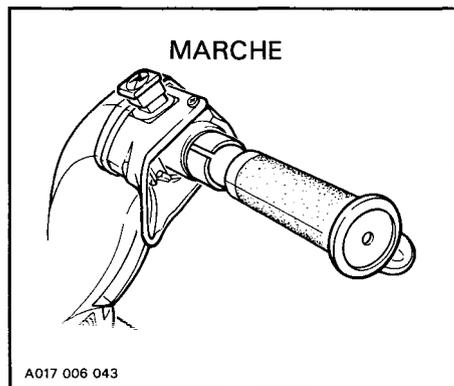
S'assurer que le capuchon coupe-circuit est en place et que la corde est rattachée au conducteur.
