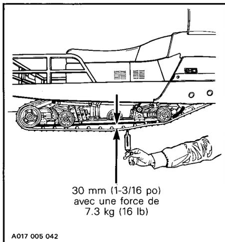
▼ **ATTENTION :** Une chenille trop tendue entraînera une perte de puissance et une tension excessive au niveau des pièces de la suspension.
