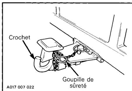
◆ **AVERTISSEMENT :** Lors du remorquage d'un traîneau ou d'une remorque, toujours s'assurer de verrouiller le crochet au moyen de la goupille de sûreté.
