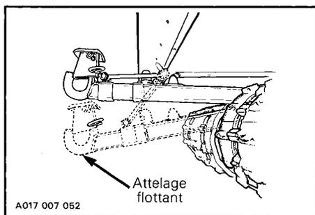
La goupille de verrouillage peut être insérée dans la goupille de sûreté lorsque l'attelage est flottant.
