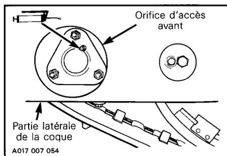
**ATTENTION : S'assurer de lubrifier les deux essieux moteurs. Il y a un raccord de graissage de chaque côté de la coque.**
