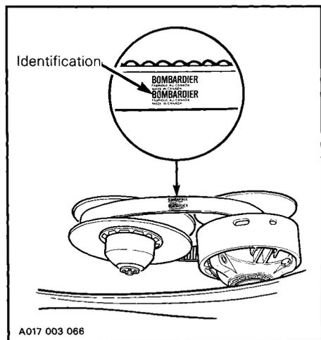
**ATTENTION :** Ne pas forcer la courroie ni utiliser d'outils pour la passer par-dessus les poulies lors de l'installation, sinon ses cordes pourraient être coupées ou se briser.
