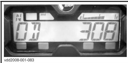
3. Wähltaste drücken und für 2 Sekunden gedrückt halten. Dies wechselt den angezeigten Modus nach Geschwindigkeit, U/min oder Kombiniert.
