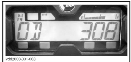
3. Wähltaste drücken und für 2 Sekunden gedrückt halten. Dies wechselt den angezeigten Modus nach Geschwindigkeit, U/min oder Kombiniert.
