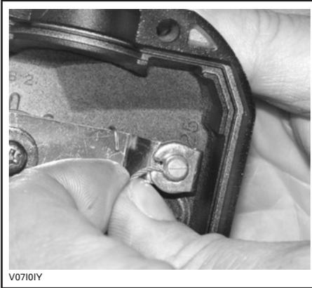
Entfernen Sie die Seitenabdeckung der Drosselklappe.
