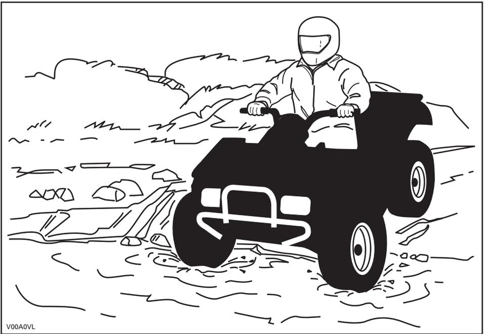
Wasser beeinträchtigt die Bremsleistung Ihres Fahrzeugs. Sorgen Sie durch mehrfaches Betätigen dafür, dass Ihre Bremsen wieder trocken werden, nachdem das Fahrzeug das Wasser verlassen hat.
