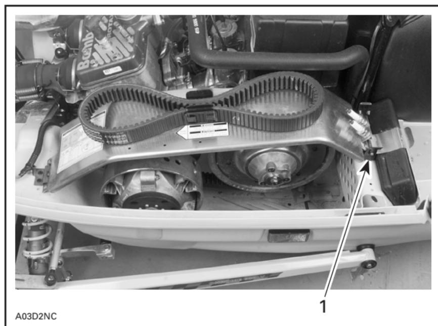
1. Dispositif de fixation de la goupille
