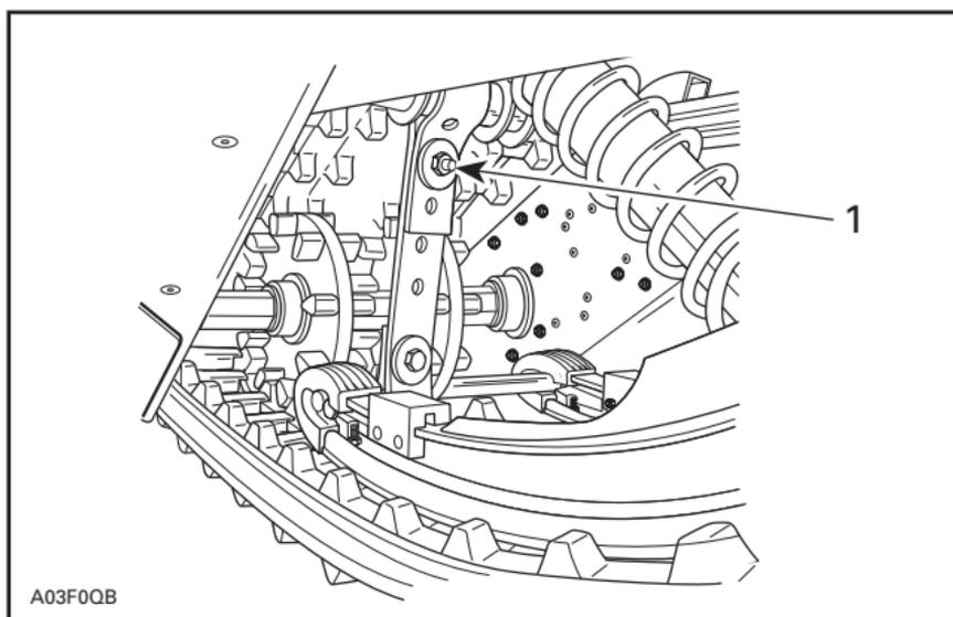
1. Pour changer la longueur de la courroie, il suffit de boulonner le tout dans un trou différent
