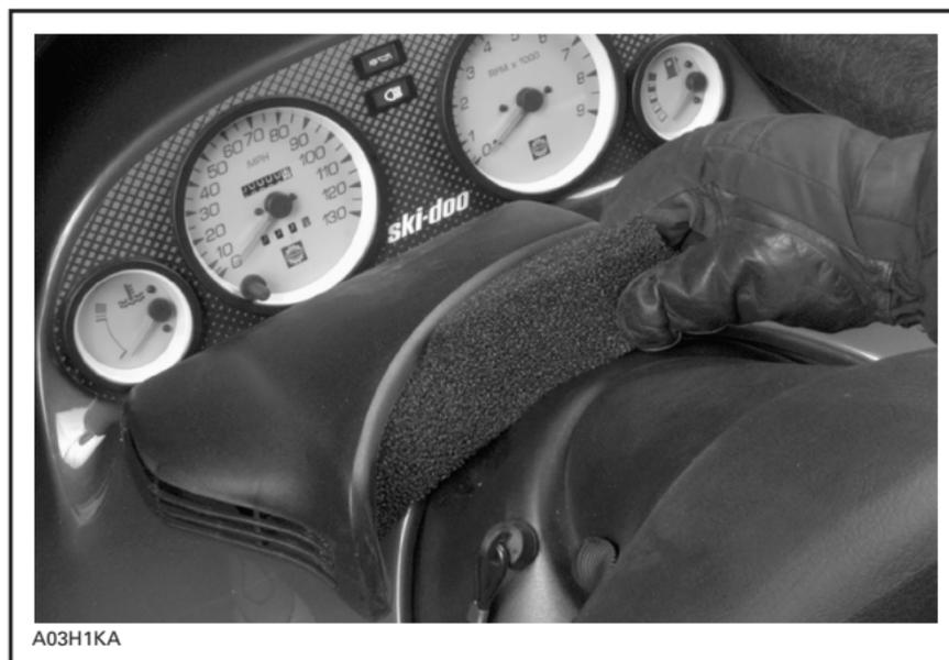
**DÉPOSE DU FILTRE**
