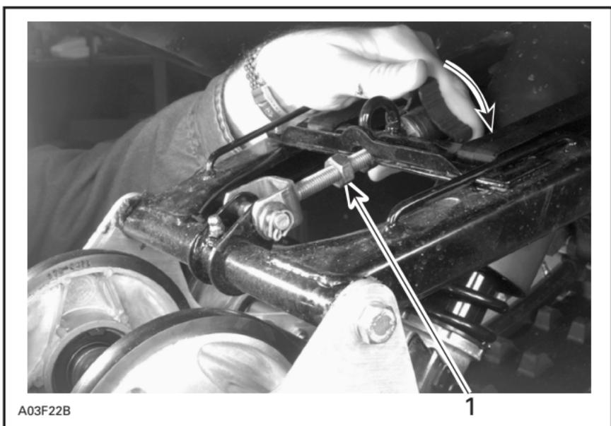
1. *Desserrer l'écrou autobloquant, tourner le bouton en conséquence, puis resserrer l'écrou autobloquant*
