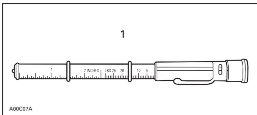
1. Vérificateur de tension pour courroies
