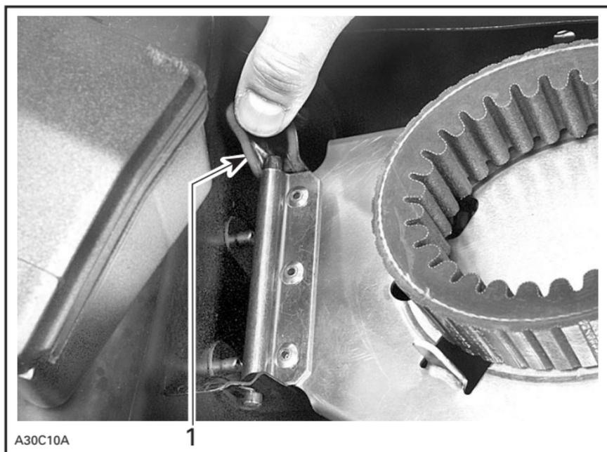
1. Dispositif de fixation de la goupille
