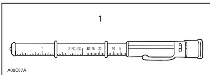
1. Vérificateur de tension pour courroies
