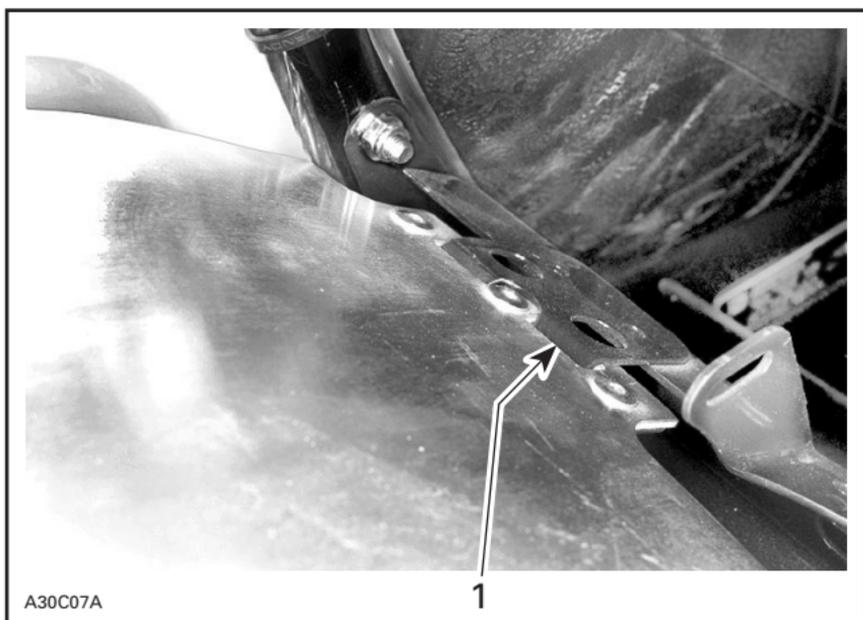
1. Arrière du garde-poulie correctement installé
