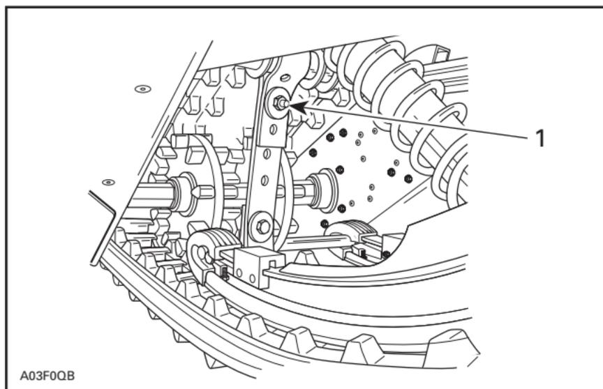
1. Raccourcir la courroie en la boulonnant à un autre orifice
