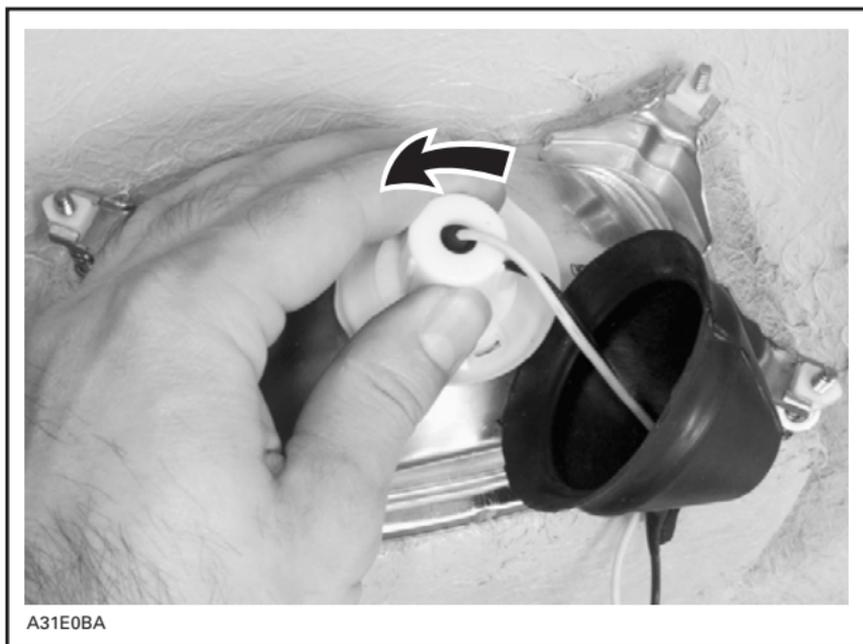
*DÉPOSE DU SOUFFLET DE CAOUTCHOUC ET DE L'ANNEAU DE RETENUE DE L'AMPOULE*
