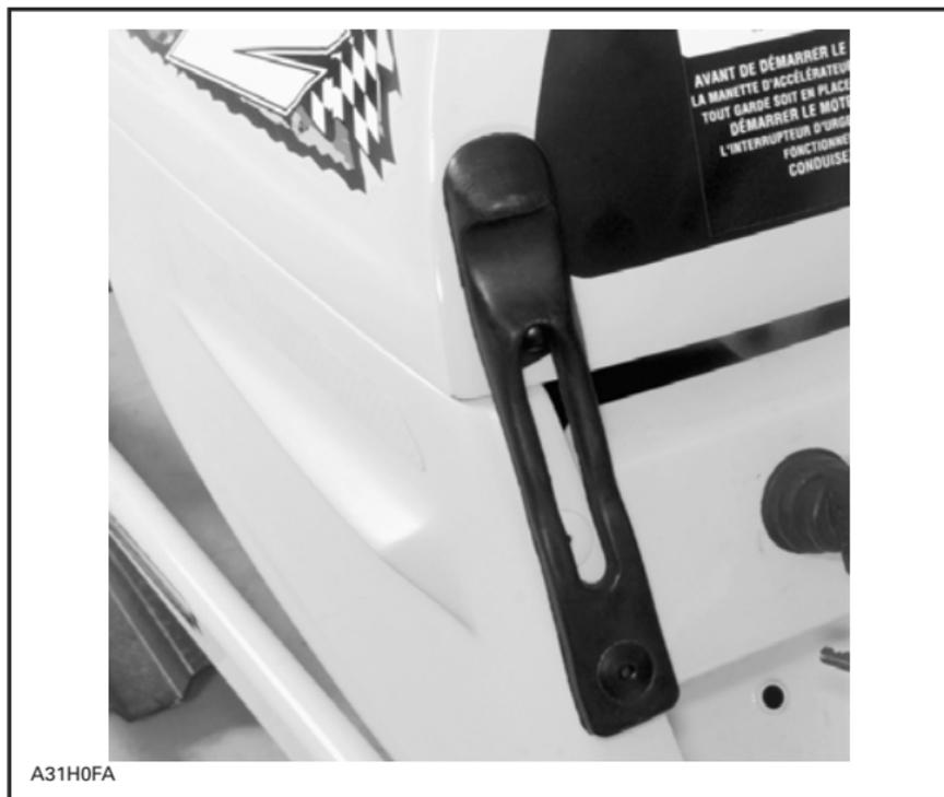
*VUE DU CÔTÉ GAUCHE — POSITION DE L'ATTACHE DE CAPOT*
