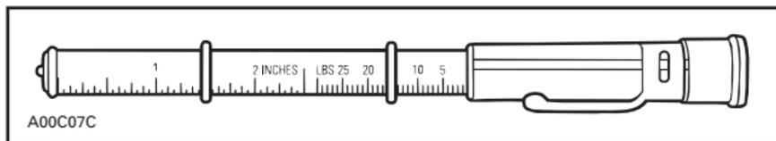
*VÉRIFICATEUR DE TENSION POUR COURROIES*
