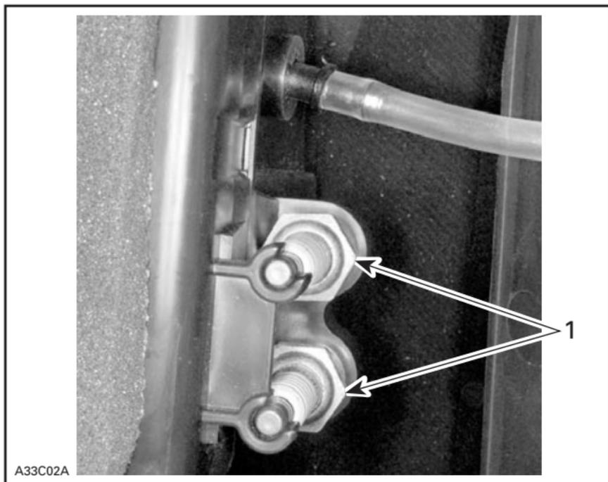
**REV SERIES — SPARK PLUG HOLDER ON LEFT HAND SIDE PANEL**
