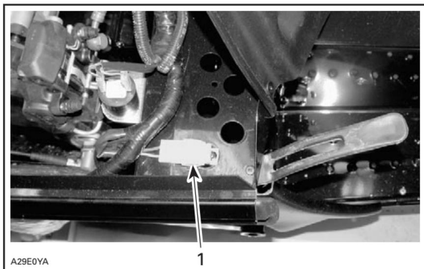
**FUSIBLE DU SYSTÈME DE DÉMARRAGE ÉLECTRIQUE ET PRISE DE COURANT —
