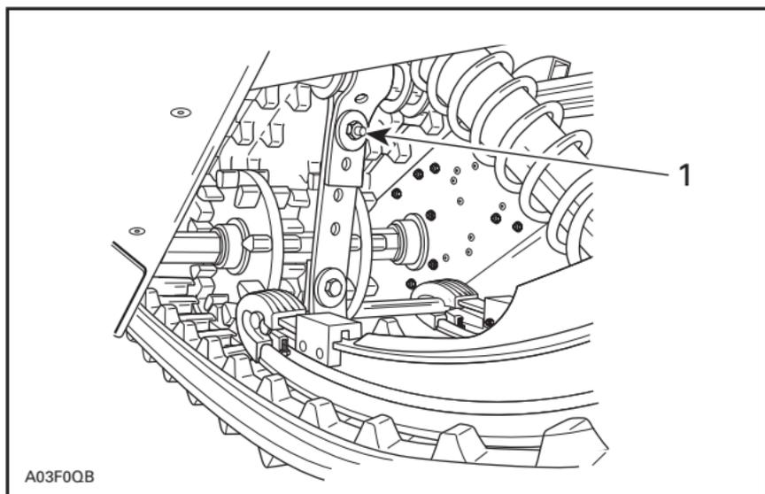
1. Pour changer la longueur de la courroie, il suffit de la boulonner dans un trou différent
