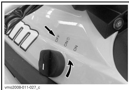
**REMARQUE:** Sur les modèles X xc et X mx, retirer de l'interrupteur d'arrêt du coupe-circuit le clip du cordon coupe-circuit arrête aussi le moteur.
