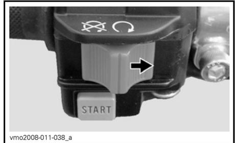
Schalten Sie auf Stellung NEUTRAL oder drücken Sie den Feststellhebel für die Kupplung.
