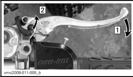
Schritt 1: Ziehen Sie den vorderen Bremshebel an und halten Sie ihn
