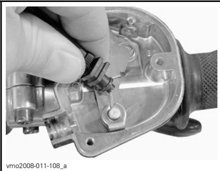
Entfernen Sie die Seitenabdeckung der Drosselklappe.
