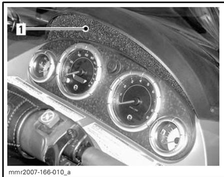
1. Filtre à air installé sur le conduit d'admission d'air
