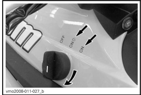
Coloque el interruptor de paro del motor en la posición RUN (marcha).
