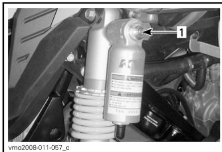
1. Ajustador de compresión (destornillador plano)
