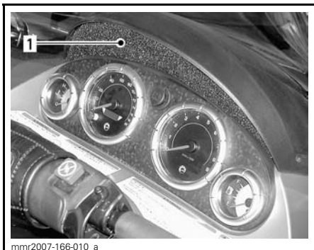
1. Luftfilter montert på luftinntakskanalen
