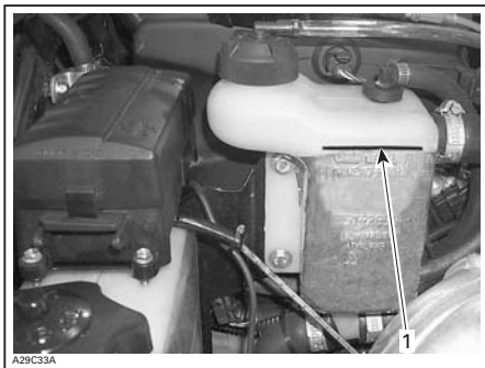
EXPEDITION TUV 600 HO SDI — EKSPANSJONSKAMMER NÆR BEHOLDEREN FOR INNSPRØYTINGSOLJE 1. Maksimalt
