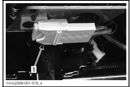
MOTORROM — UNDER KONSOLL 1. Sikringsholder
