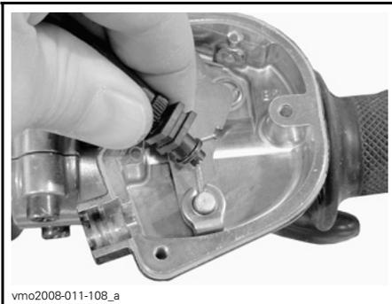
Entfernen Sie die Seitenabdeckung der Drosselklappe.
