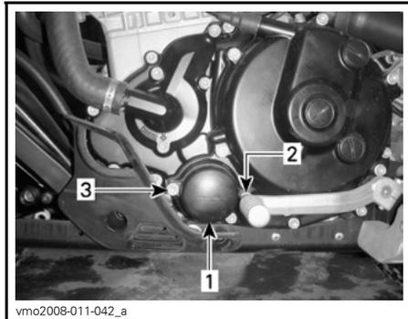
Öltank mit 1,8 l (1,9 U.S. quarts) des empfohlenen Öls auffüllen. Weitere Einzelheiten finden Sie in diesem Abschnitt unter **EMPFOHLENES MOTORÖL**.
