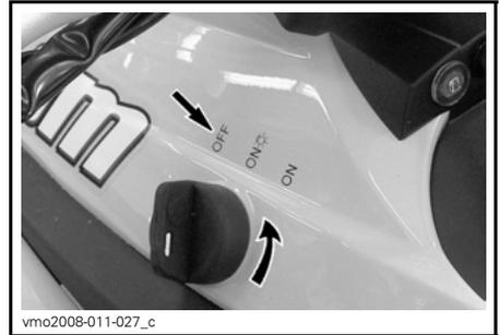
**Hinweis:** Bei dem Modell X xc wird der Motor auch durch Abziehen des Gurts mit Sicherheitsstecker vom Sicherheitsstoppschalter ausgeschaltet.
